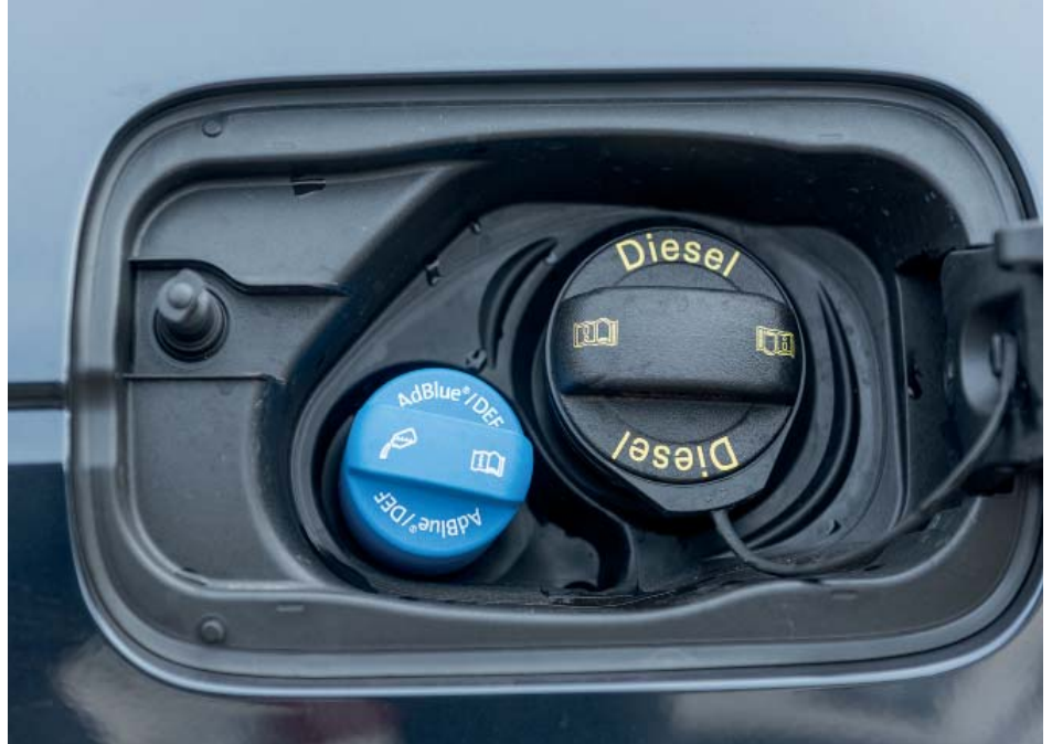
Zwei Tanks für Sprit und für das Additiv sind bei Dieselaautos heute häufig
